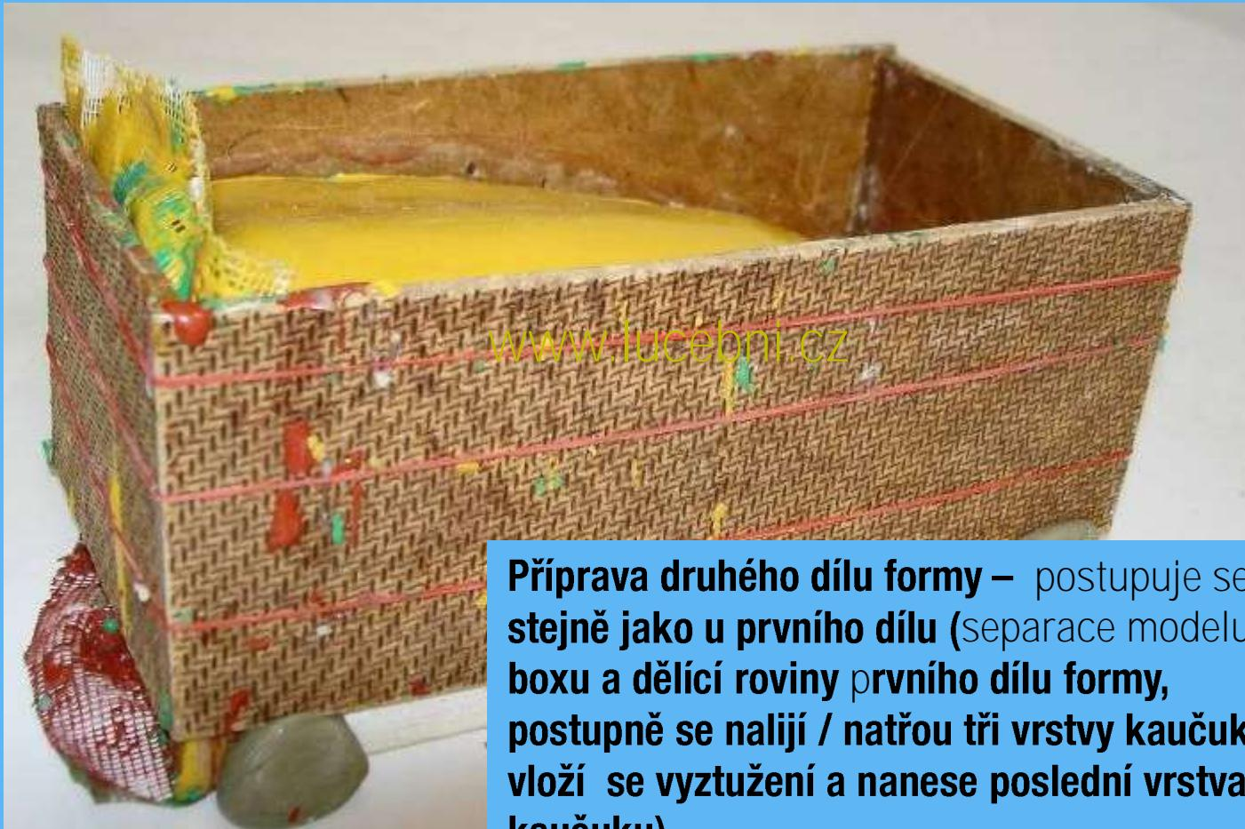
**Příprava druhého dílu formy –** postupuje se stejně jako u prvního dílu (separace modelu, boxu a dělící roviny prvního dílu formy, postupně se nalijí / natřou tři vrstvy kaučuku, vloží se vyztužení a nanese poslední vrstva kaučuku).
